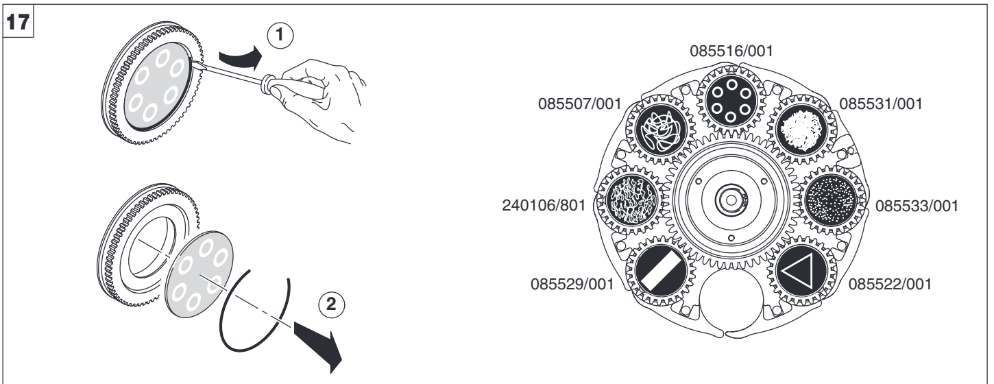
Remplacement gobos rotatifs (Ø 25.7 mm - image max 23 mm - épaisseur 1.1 mm) - Fig. 17
